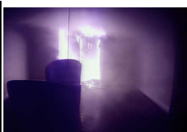
(d) 653 s Post Ignition – Right Pane Failure
